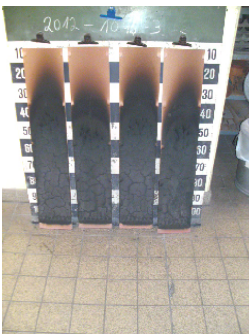
Aussehen der Probe C nach dem Brandschachtversuch
