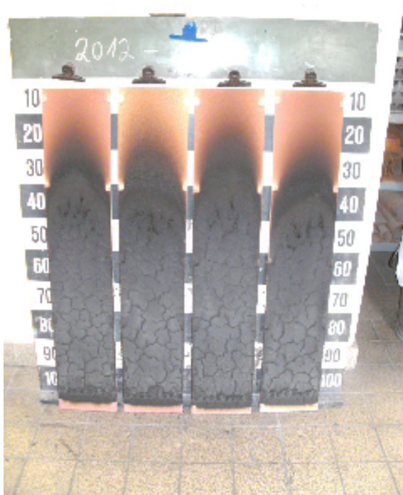
Aussehen der Probe A nach dem Brandschachtversuch
