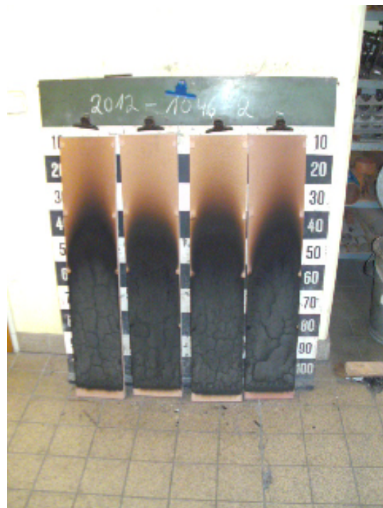
Aussehen der Probe B nach dem Brandschachtversuch
